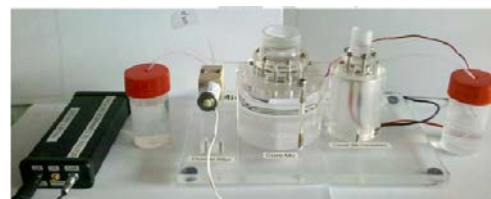
Figure 2 : Photo du prototype n°2 ANESIS avec le boîtier électronique de la pompe, le réservoir d'entrée, la pompe, la cuve Mo, la cuve de détection du LEGOS et le réservoir de sortie.
