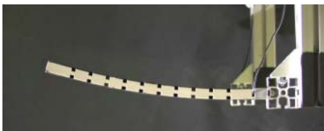
Fig. 3 : Actuation d'une voilure par des câbles en alliage à mémoire de forme.
